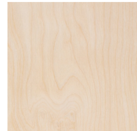
xx-xx Vast meubilair en balustrades hoofdtrap Berken multiplex
